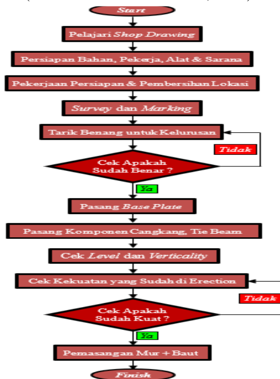
Gambar 5. Flowchart Pelaksanaan Erection (Sumber : Dokumen Proyek, 2025)
